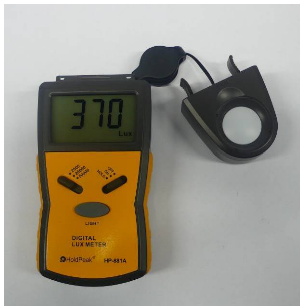
Figuur 2. Een luxmeter
